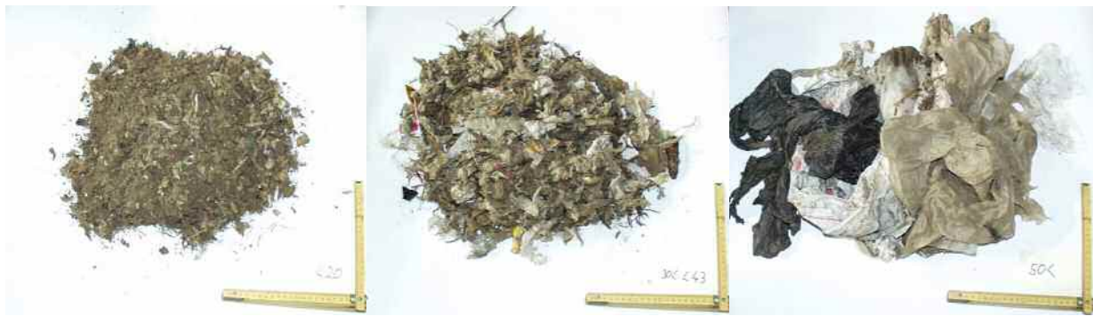
Abbildung 4 Siebfractionen (fein, mittel grob) nach der dynamischen Behandlung (Inputmaterial: unzerkleinerter Restabfall)
