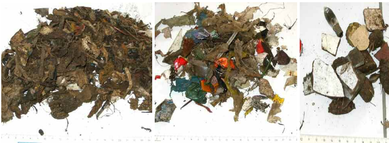
Abbildung 6 Stoffgruppen der Mittelfraktion nach händischer Sortierung (Inputmaterial: unzerkleinerter Restabfall)
